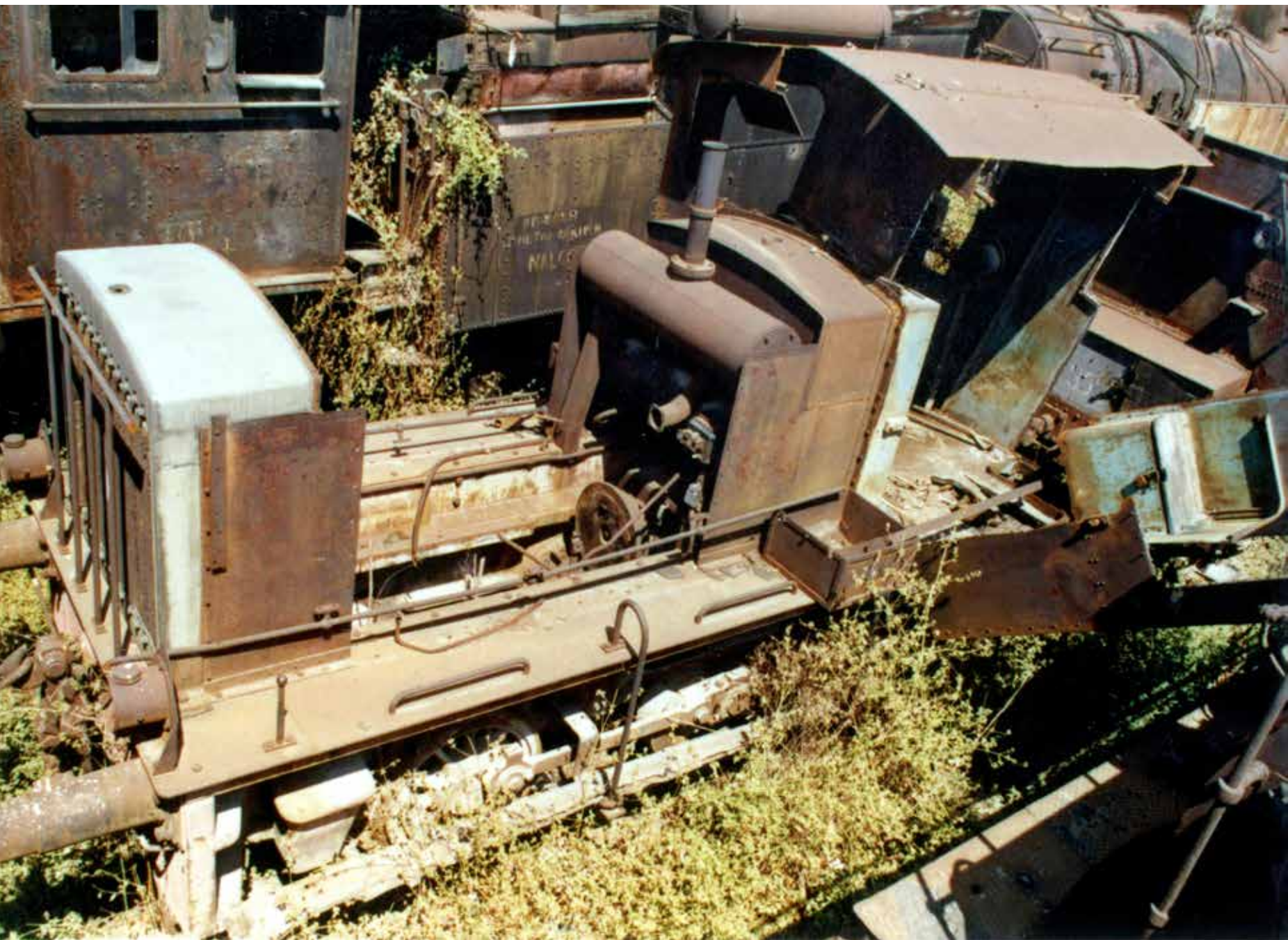
Σ | Η δεζελάμαξα Α 6 (Esslingen 4280/35), εγκαταλελειμμένη στους χώρους του ΣΟΜ στις 4 Αυγούστου του 1985, είναι έτοιμη για την διάλυσή της. Έχει από χρόνια αφαιρεθεί ο ντηζελοκινητήρας και το κιβώτιο, ενώ ο θάλαμος μηχανοδότησης έχει ήδη κοπεί με συσκευές οξυγόνου (αρχείο Γ. Φλώρου).
