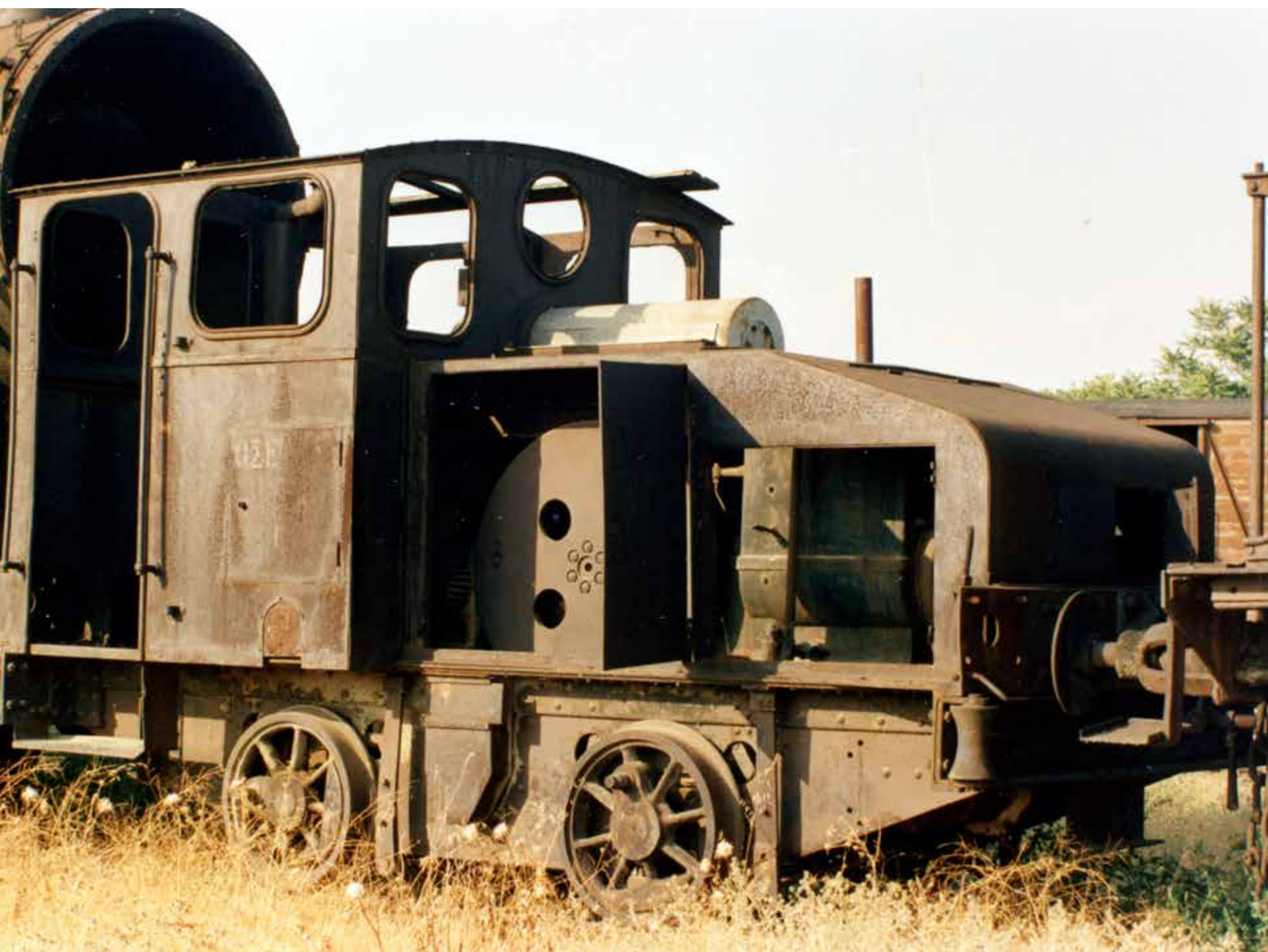
Σ | Η δηζελάμαξα Α5, κατασκευής Deutz τύπου C XIV R, εγκαταλελειμμένη στους χώρους του ΣΟΜ (αρχείο Φ. Έλλιουτ)
