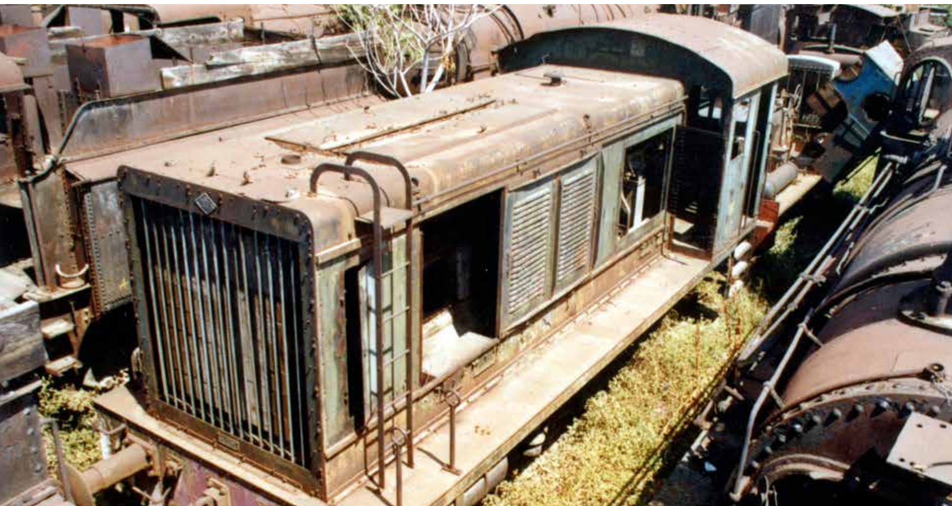
Σ | Η δηζελάμαξα V36 υπ' αριθμόν Α 7 (MBAG 21487/43), εν αναμονή της διάλυσής της στους χώρους του ΣΟΜ, στις 4 Αυγούστου 1985. Ο θάλαμος μηχανοδήγησης έχει ήδη αποκοπεί από το πλαίσιο με συσκευές οξυγόνου (αρχείο Γ. Φλώρου)
