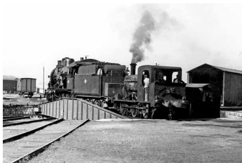
Σ | Η «ΜΑΡΙΝΑ» εργάστηκε ακούραστα για πολλά χρόνια στο Μηχανοστάσιο Αγ. Ιωάννη, σε κάθε μορφής καθήκοντα. Εδώ, κατά τη διαδικασία ώθησης ατμάμαξας της σειράς Λα. στην περιστροφική πλάκα. Δεκαετία του '30. (Αρχειο ΟΣΕ).
