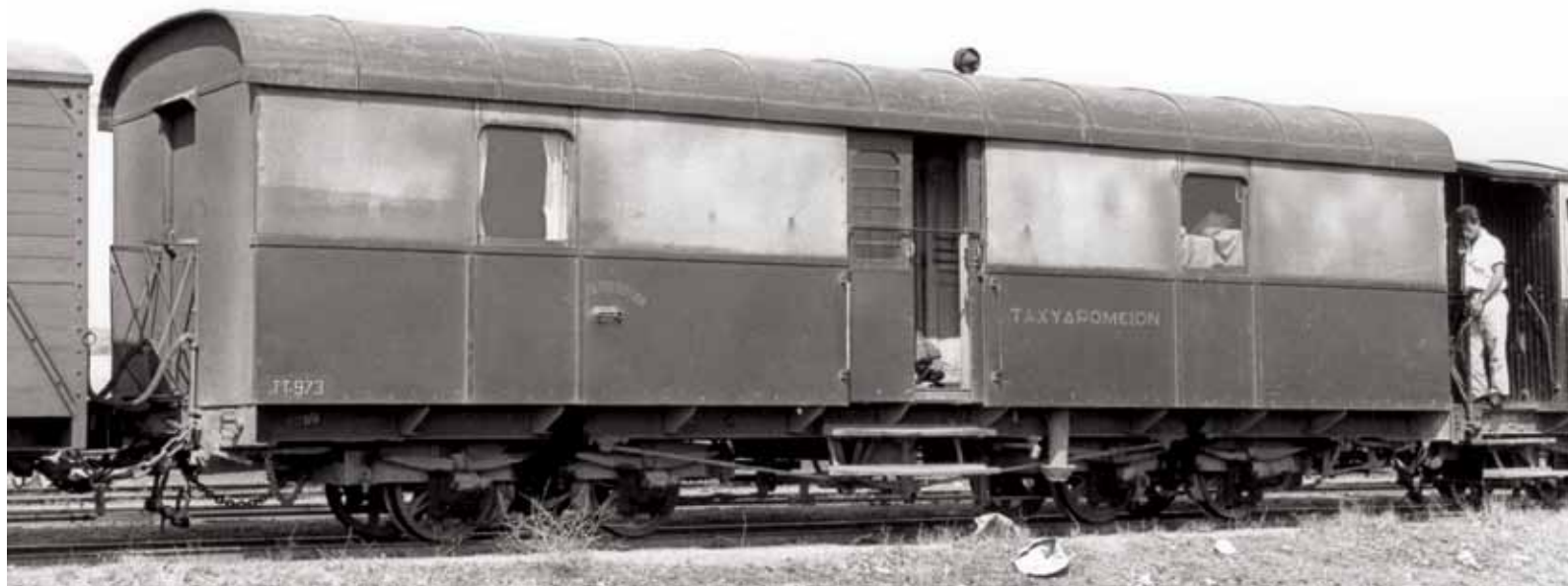
Σ. | Το ταχυδρομικό όχημα των ΣΠΑΠ, ΤΤ 973 (σειρά ΤΤ 971-975), κατασκευής του 1920. Δίπλα στην αριστερή πόρτα διακρίνεται η σχισμή της θυρίδας του γραμματοκιβωτίου του. Καλαμάκι, 30 Ιουλίου 1959 (Α. Luft).
